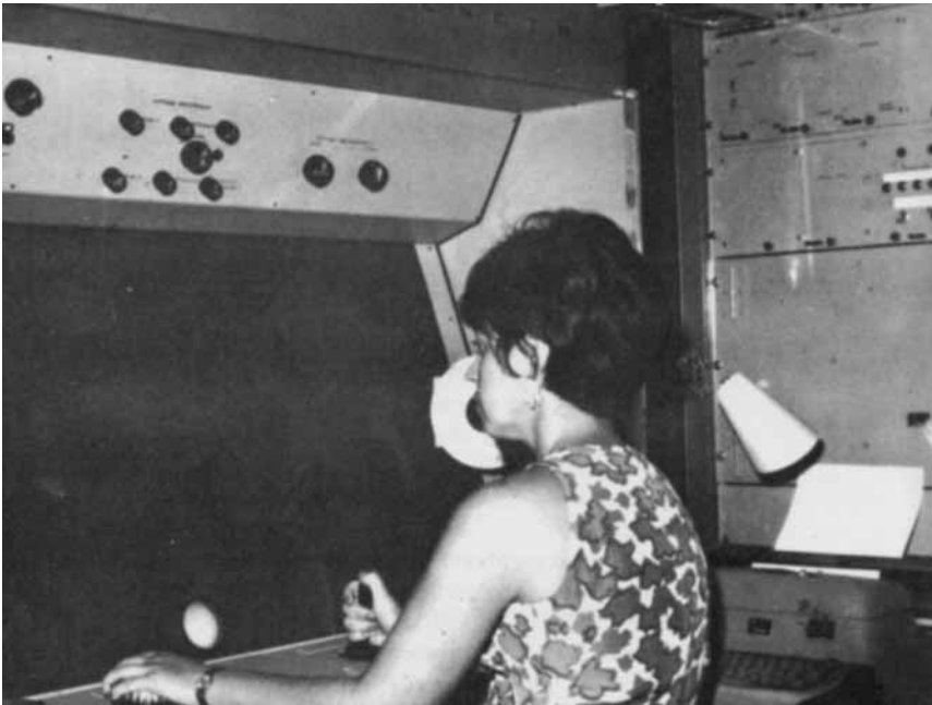
Εικόνα 4: Η Ελένη Αγορίτσα χρησιμοποιεί τη μηχανή μετρήσεως ιχνών τροχιών σωματιδίων πάνω σε φωτογραφίες από θαλάμους φυσαλίδων (Πηγή: Πεπραγμένα 1967)
